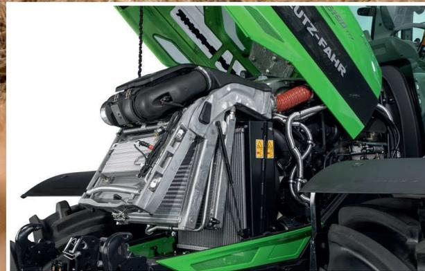
Aluminium-Kühler des 6210 TTV, 6230 TTV und 6230 TTV HD mit praktischem Klappmechanismus und Powercore-Luftfilter.
